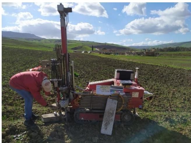
**Foto 9** – Penetrometro Pagani per l'esecuzione di prove penetrometriche statiche CPT
