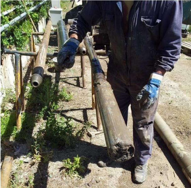
**Foto 4:** Campionatore Shelby e fustella a pareti sottili impiegati per il prelievo di campioni indisturbati.
