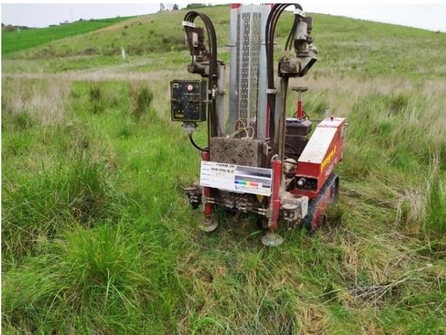
**Foto 10 – Penetrometro Pagani per l'esecuzione delle prove penetrometriche dinamiche DPSH**
