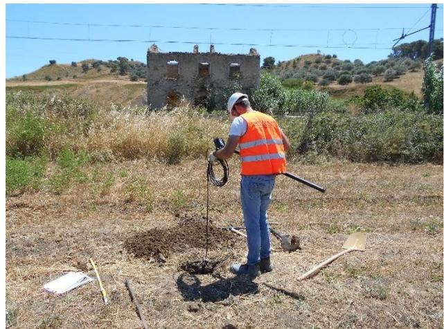
**Foto 2:** Esecuzione di ricerca di masse metalliche superficiali e in foro mediante magnetometro MAGNEX della VOLTA
