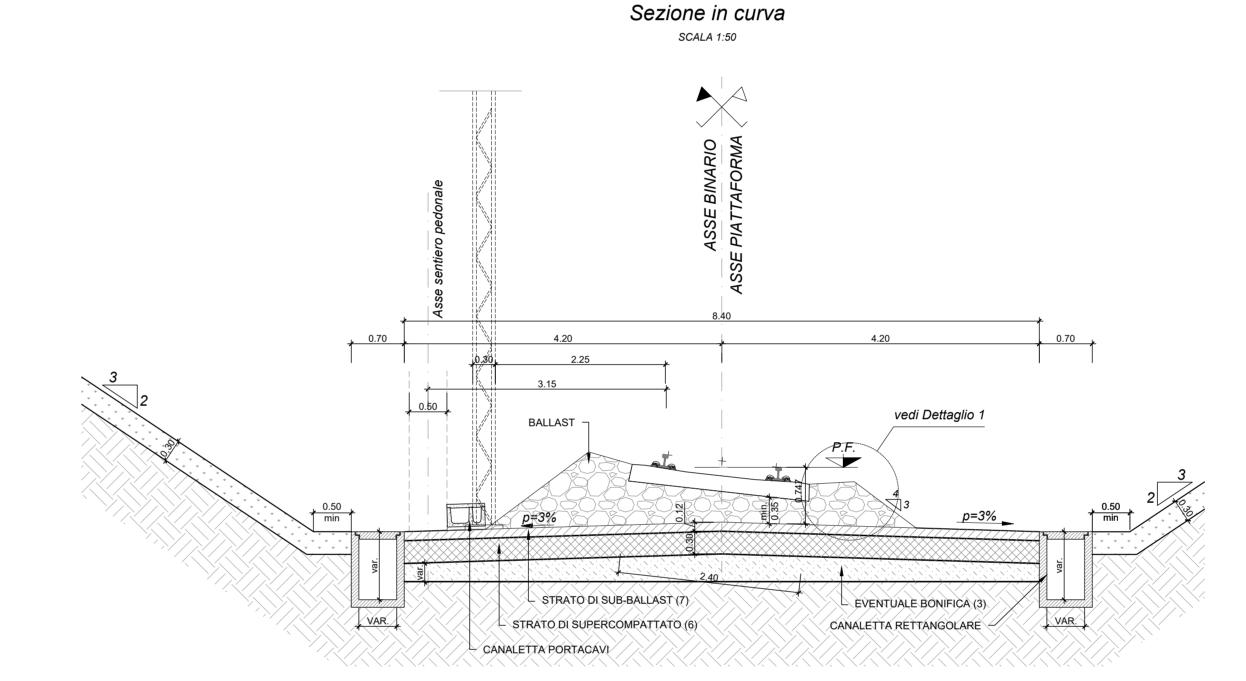
Sezione tipo a singolo binario in trincea
