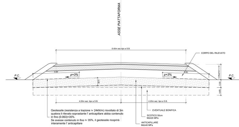
Sezione tipo in rilevato -  $H_{rfl} \geq 1,10 \text{ m}$
