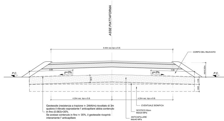
Sezione tipo in rilevato -  $0,90\text{m} \leq H_{rfl} < 1,10 \text{ m}$
