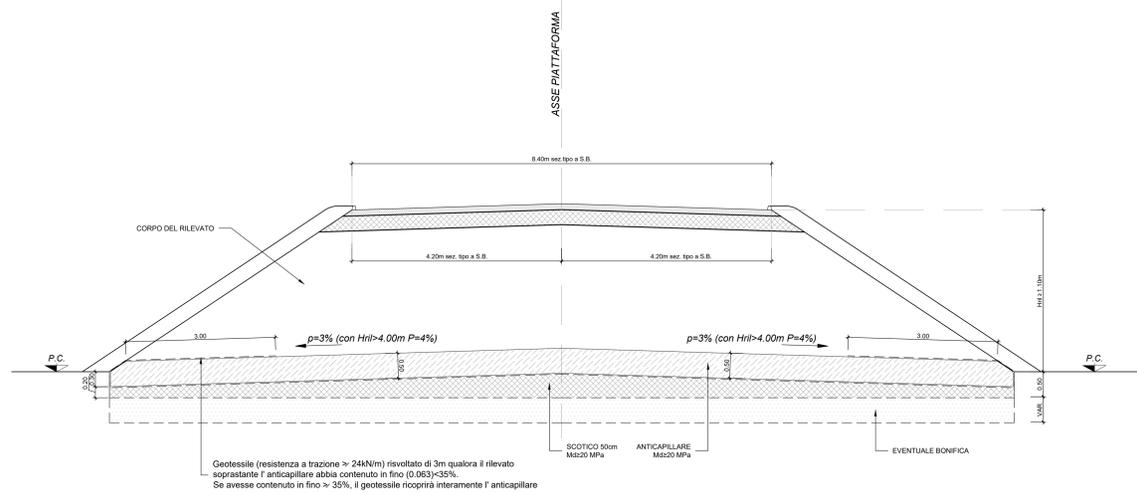
Sezione tipo in rilevato - Piano di posa inclinato con  $p > 15\%$
