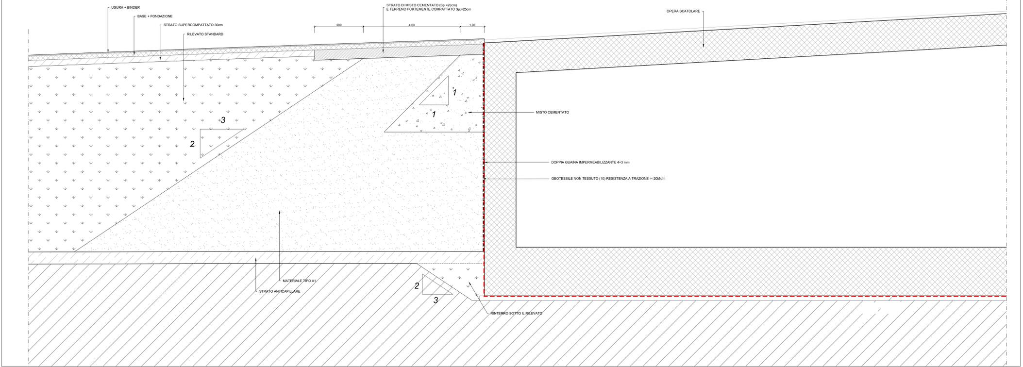
ZONA DI TRANSIZIONE RILEVATO STRADALE/SCATOLARE H<=4.00m
