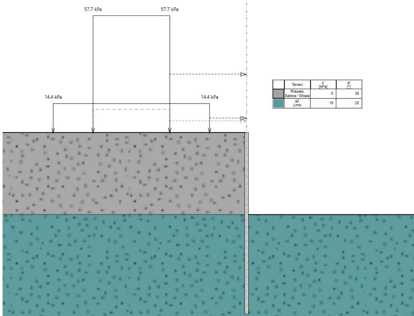
Figura 8-1 – Schema di calcolo paratia: modello 01.
