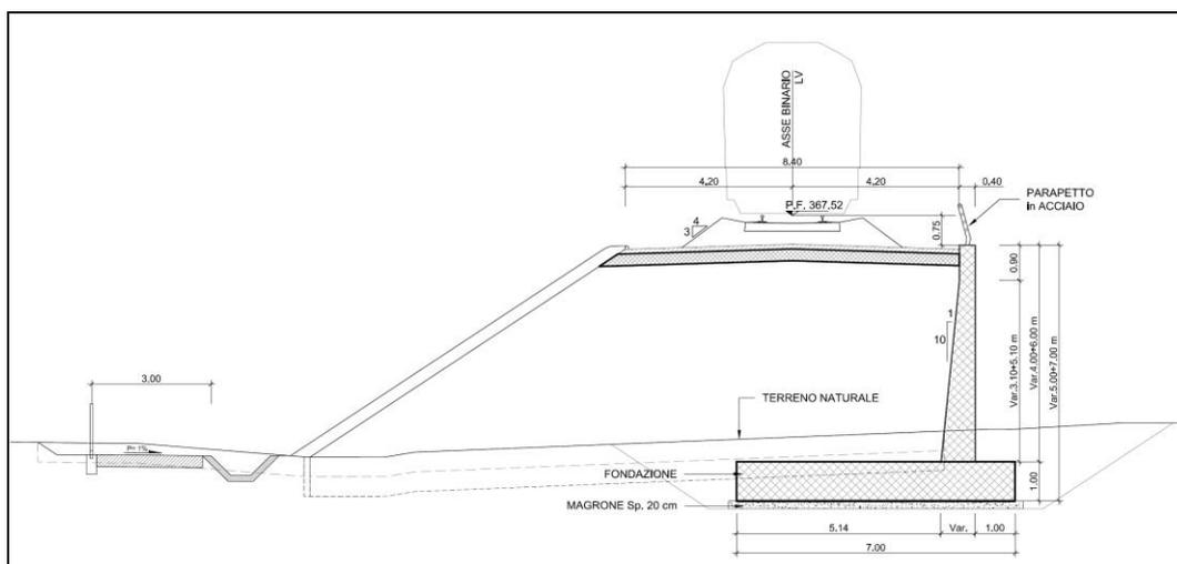
Figura 1-3 – RI10: Muro di sostegno in sx MU56 – Sezione trasversale muro tipo 2.
