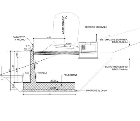
MURO DI SOSTEGNO TIPO "3"
