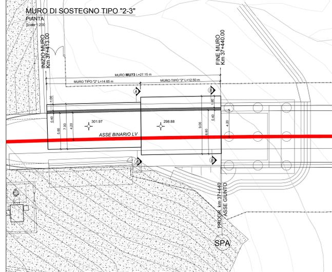
MURO DI SOSTEGNO TIPO "2"
