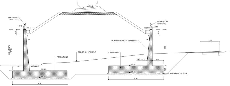
MURO MU73 - VI12 spalla A - lati SX/DX
