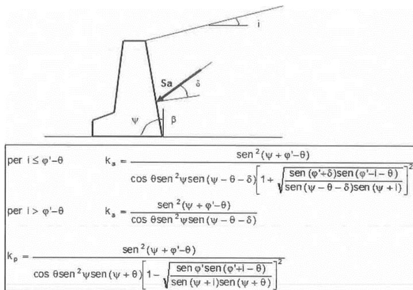
Figura 8-3 – Coefficiente di spinta attiva e passiva.
