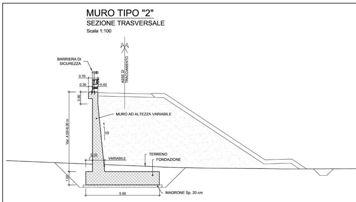
Figura 1-4 – NV53A: Muro di sostegno MU80B - Sezione.
