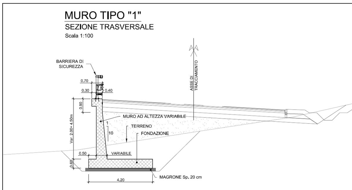
Figura 1-3 – NV53A: Muro di sostegno MU80B - Sezione.
