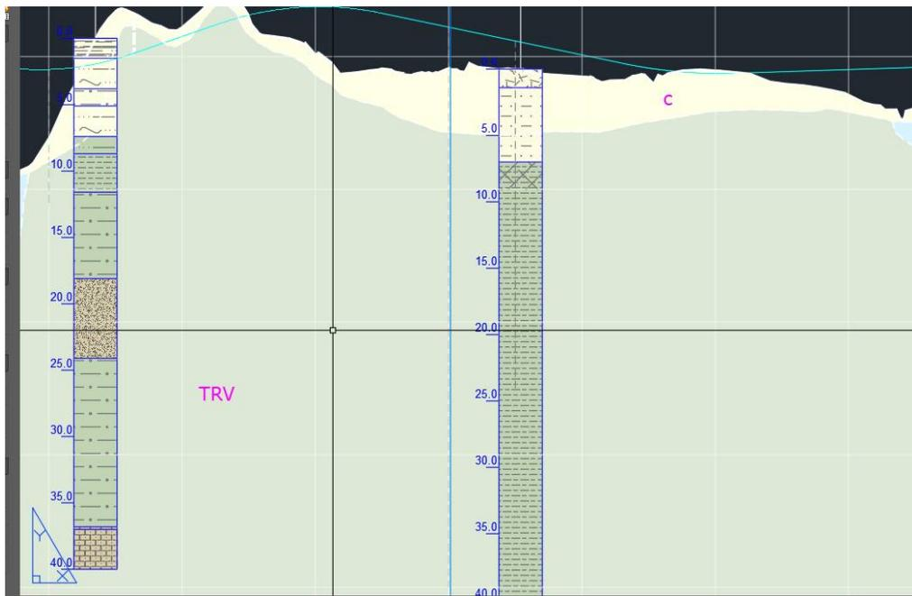
Figura 6-1 – Stralcio del profilo geotecnico.
