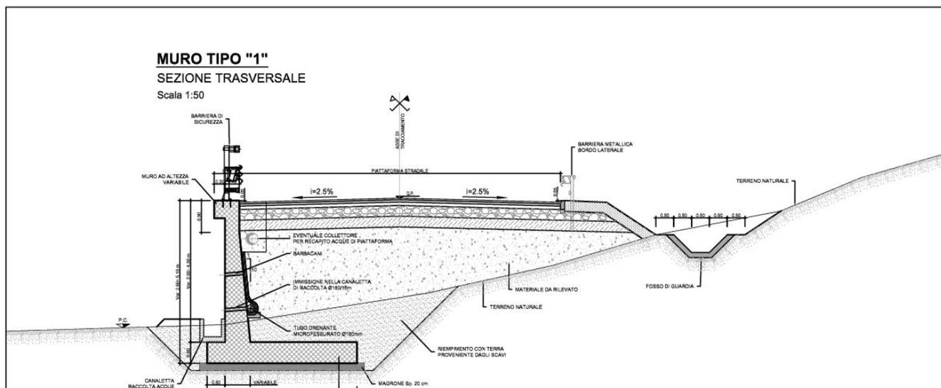
Figura 1-3 – NV53A: Muro di sostegno MU80A - Sezione.
