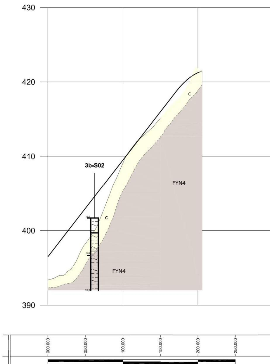
Figura 6-1 – Stralcio del profilo geotecnico.
