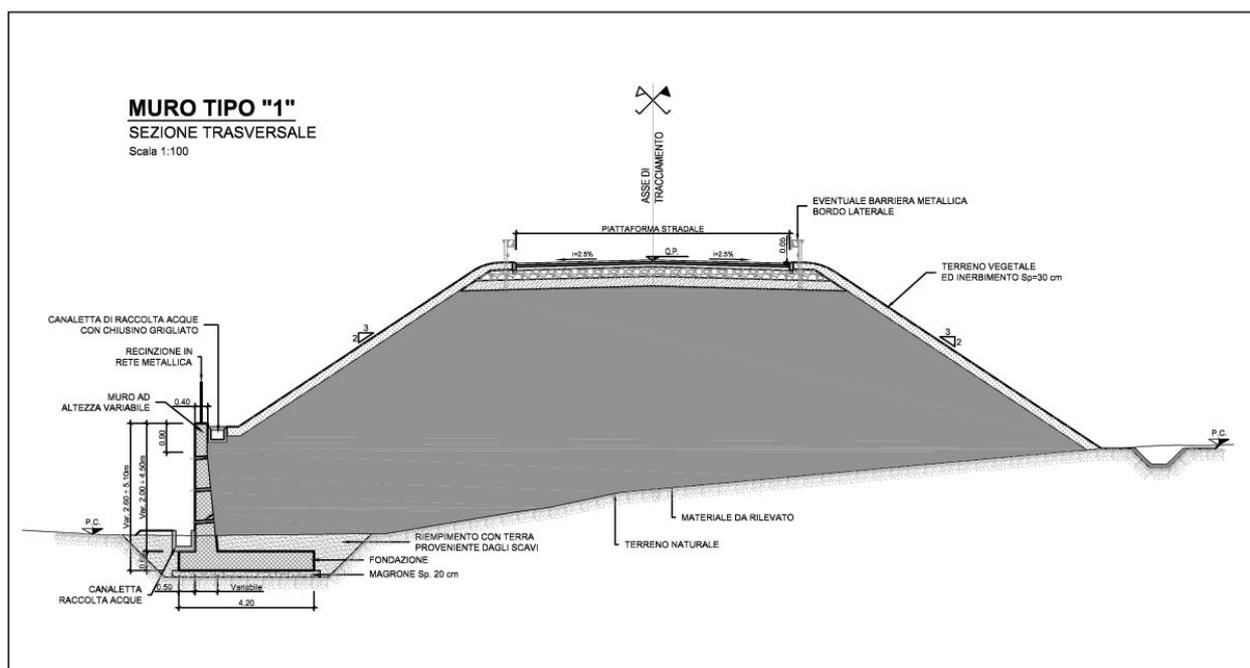
Figura 1-3 – NV64: Muro di sottoscarpa MU87 - Sezione.
