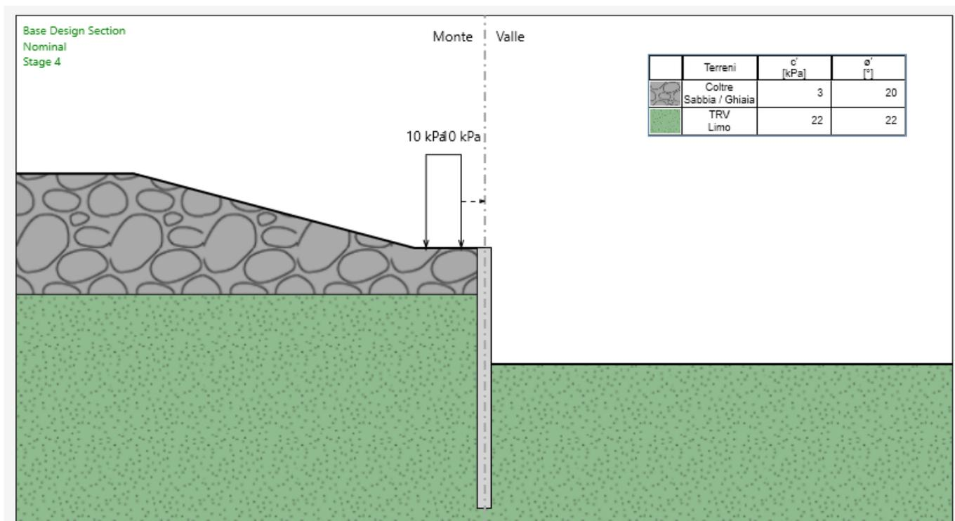
Figura 11-1. Schema di calcolo paratia
