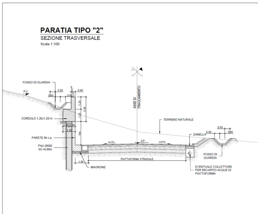
Figura 1-3 – Sezione trasversale paratia tipo 2.
