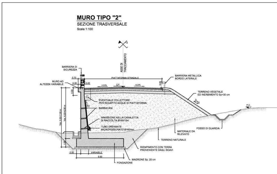
Figura 1-4 – NV66: Muro di sostegno MU89 - Sezione.
