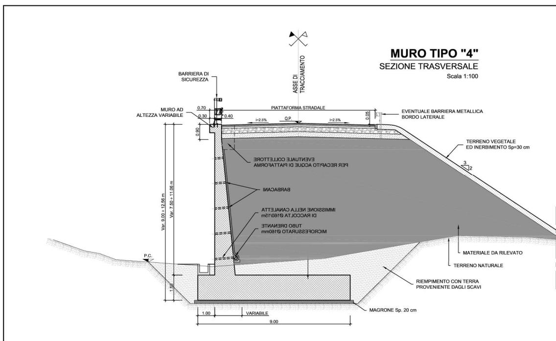
Figura 1-6 – NV66: Muro di sostegno MU89 - Sezione.
