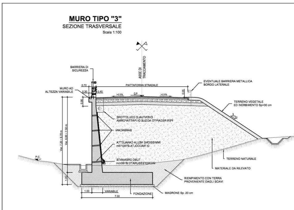
Figura 1-5 – NV66: Muro di sostegno MU89 - Sezione.
