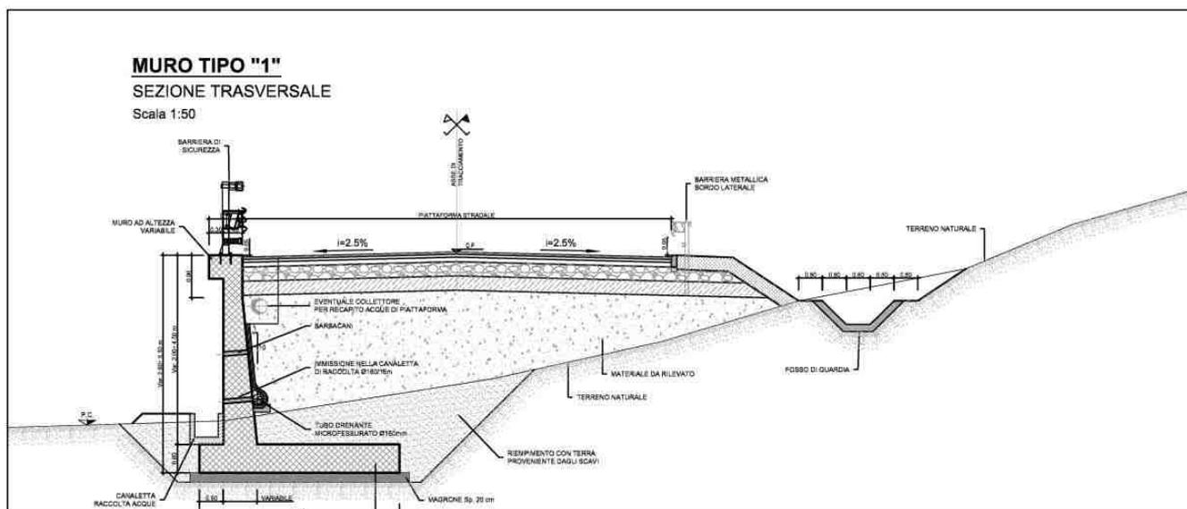
Figura 1-3 – NV66: Muro di sostegno MU89 - Sezione.
