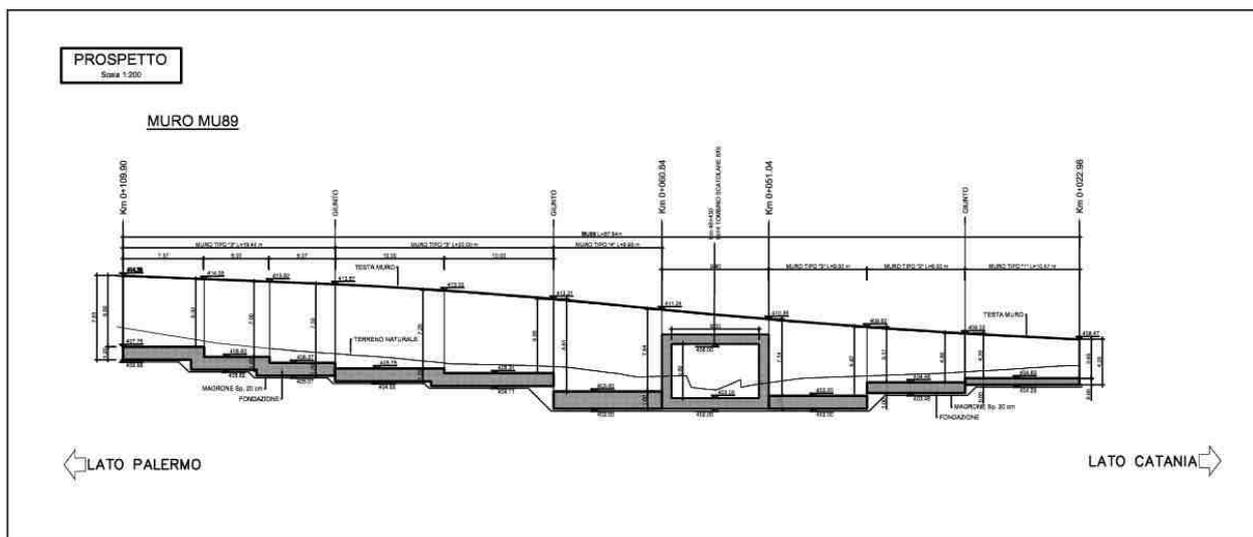
Figura 1-2 – NV66: Muro di sostegno MU89 - Prospetto.
