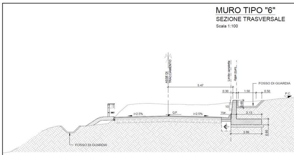
Figura 1-3 – Sezione trasversale muro tipo 6.
