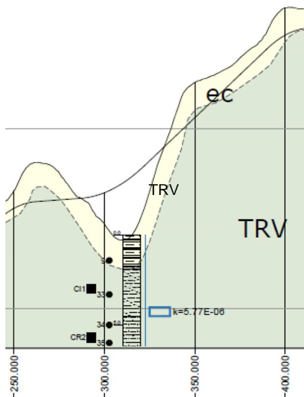
Figura 6-1 – Stralcio del profilo geotecnico.
