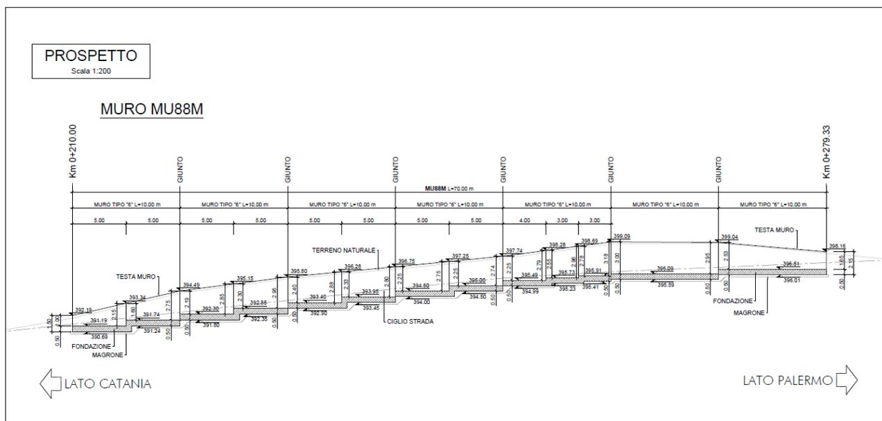
Figura 1-2 – Prospetto MU88M.
