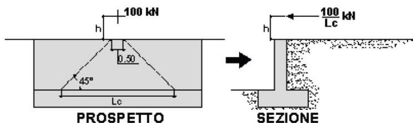
Figura 8-8 – Schema di diffusione della forza di collisione.
