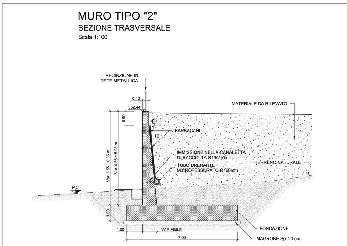
Figura 1-4 – NV63: Muro di sostegno MU93 – Sezione tipo 2.
