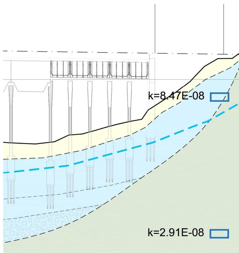
Figura 6-1 – Stralcio del profilo geotecnico.
