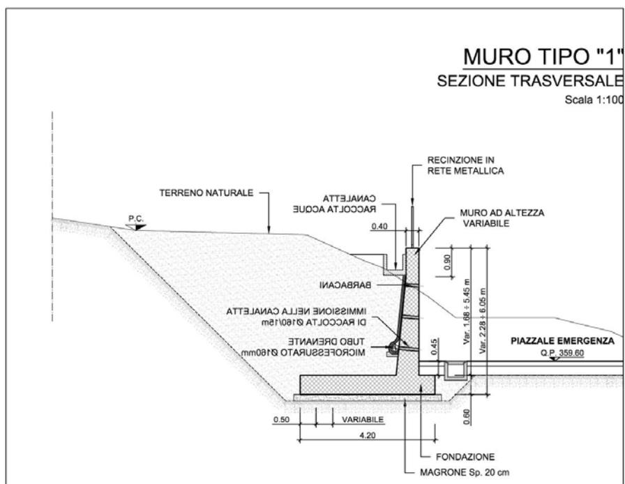
Figura 1-4 – PT56: Muro di sostegno MU96A- Sezione tipo 1.
