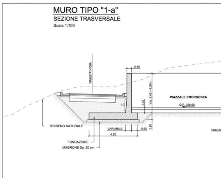
Figura 1-3 – PT56: Muro di sostegno MU96A- Sezione tipo 1a.
