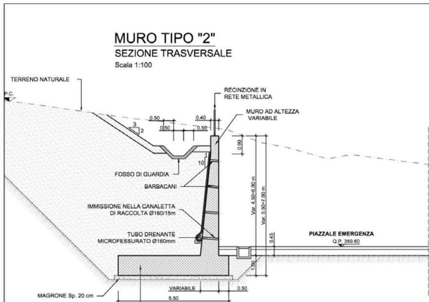
Figura 1-5 – PT56: Muro di sostegno MU96A- Sezione tipo 2.
