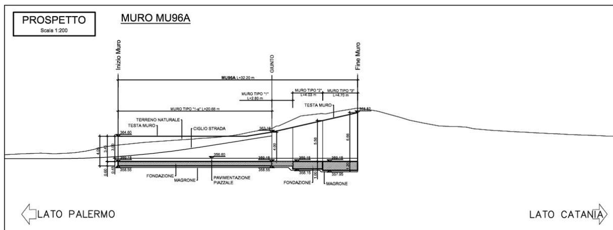
Figura 1-2 – PT56: Muro di sostegno MU96A - Prospetto.
