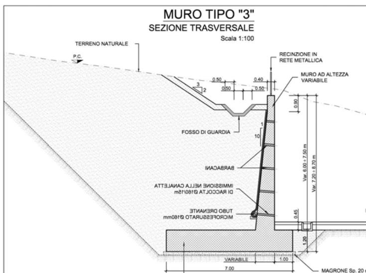
Figura 1-6 – PT56: Muro di sostegno MU96A- Sezione tipo 3.
