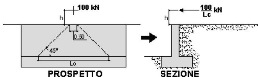
Figura 8-6 – Schema di diffusione della forza di collisione.
