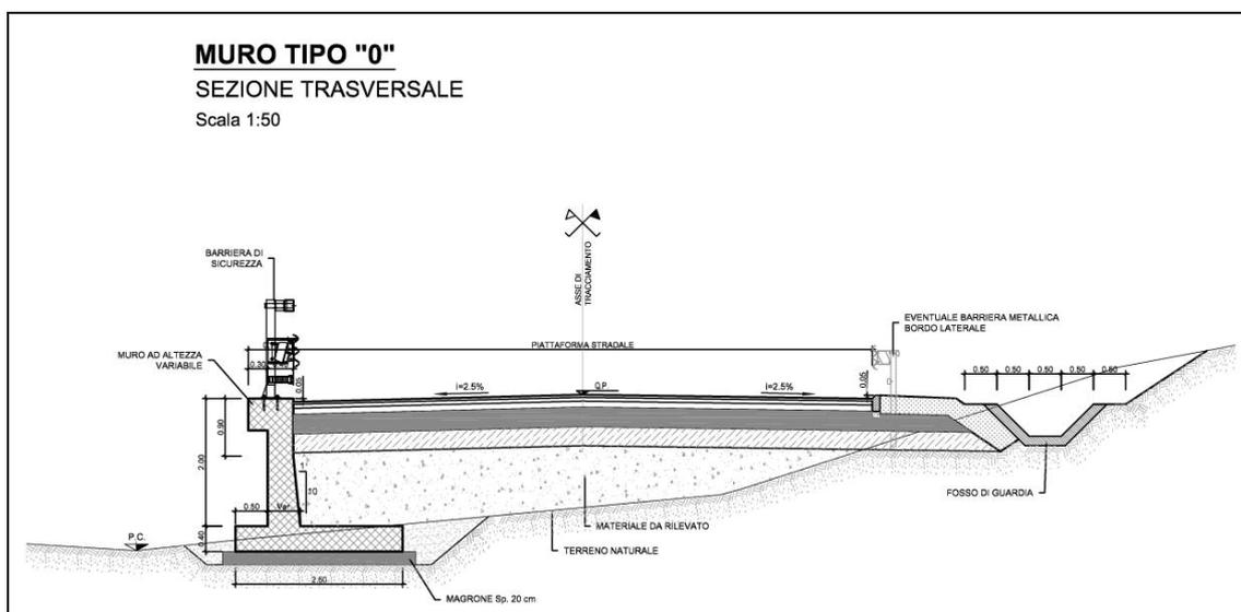
Figura 1-3 – NV57: Muro di sostegno MU82- Sezione tipo 0.
