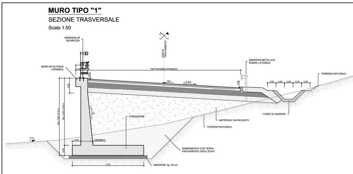
Figura 1-4 – NV57: Muro di sostegno MU82- Sezione tipo 1.
