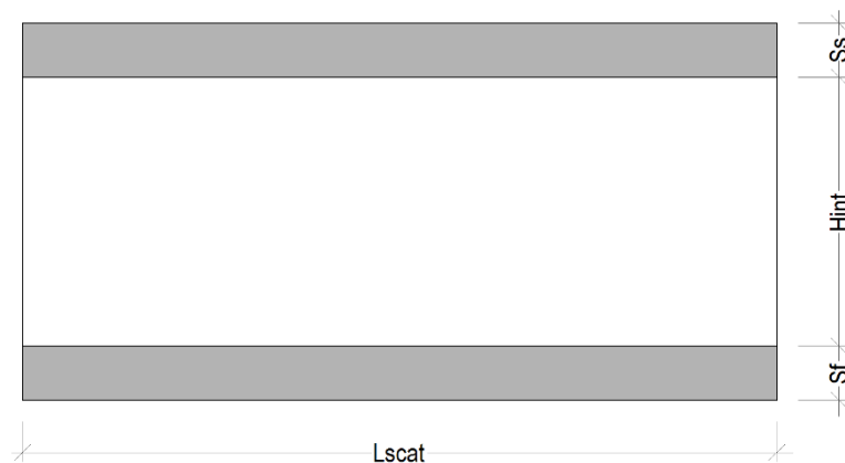
Figura 1. Sezione longitudinale dello scatolare
