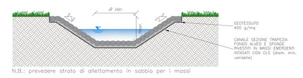
SEZIONE TIPO CAMBIO SEZIONE
