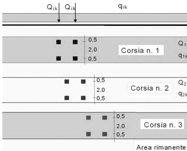
Schema di carico 1 (dimensioni in metri)
