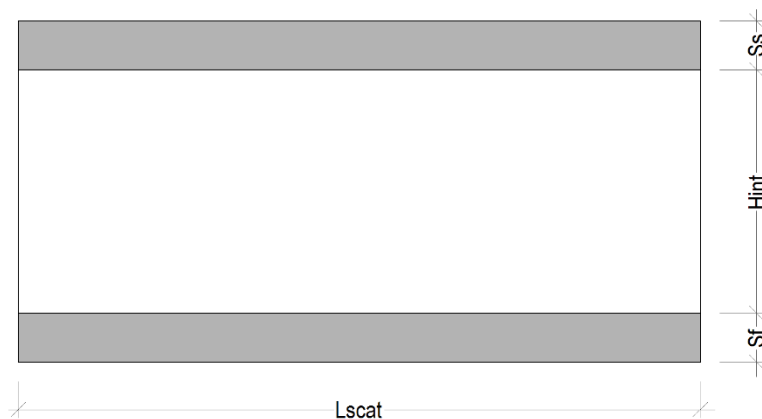
Figura 1. Sezione longitudinale dello scatolare
