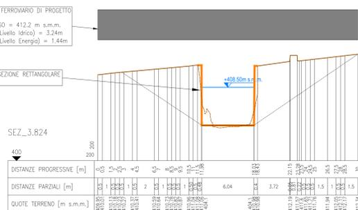
Sezione a monte del viadotto - Passaggio da sezione rettangolare a trapezia
