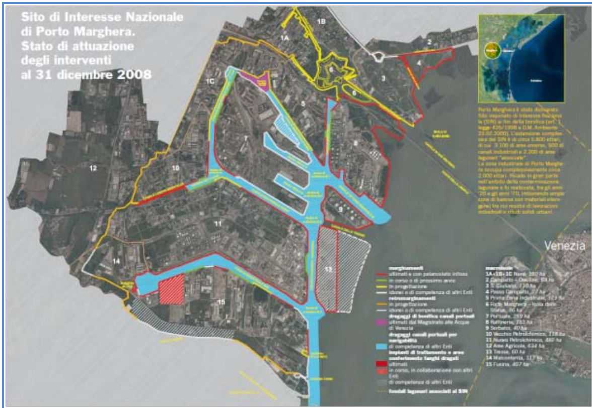
Figura II.2 – Magistrato alle Acque di Venezia - Opere di marginamento (c.a. 50 km) e avanzamento lavori 2008
