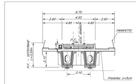
SEZIONE TIPO ACCIAIO 40M
