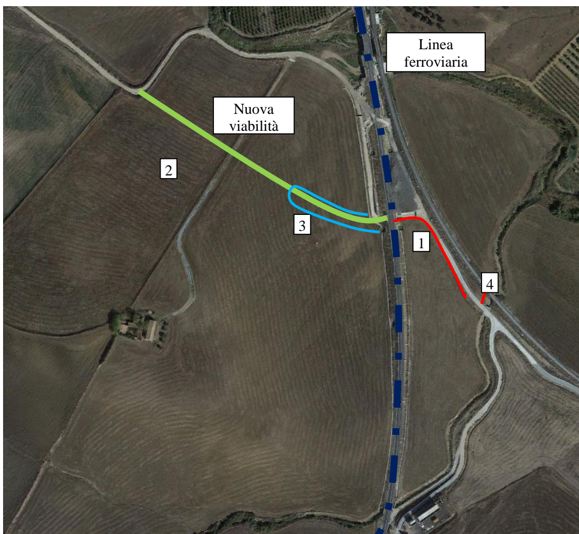
Figura 5-41 – Soluzione ST2 per la messa in sicurezza idraulica del sottovia e della strada a servizio dello stesso.
