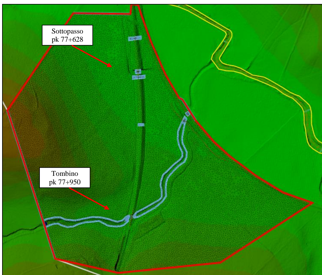
Figura 4-16 – Estensione del modello idraulico dell'affluente sinistro del rio Torto: in rosso sono evidenziati i limiti del dominio di calcolo 2D e in azzurro la zona di magliatura dell'affluente.
