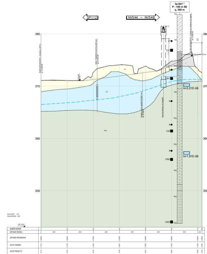
NOTA 1: lo strato superficiale di coltre eluvio-colluviale (spessore < 3 m) è stato rappresentato nel profilo idrogeologico, in base alle informazioni delle indagini in sito. La rappresentazione grafica della coltre eluvio-colluviale è stata omessa dalle carte geologiche, con l'esclusione di accumuli locali di maggiore spessore, situati alla base dei versanti.
