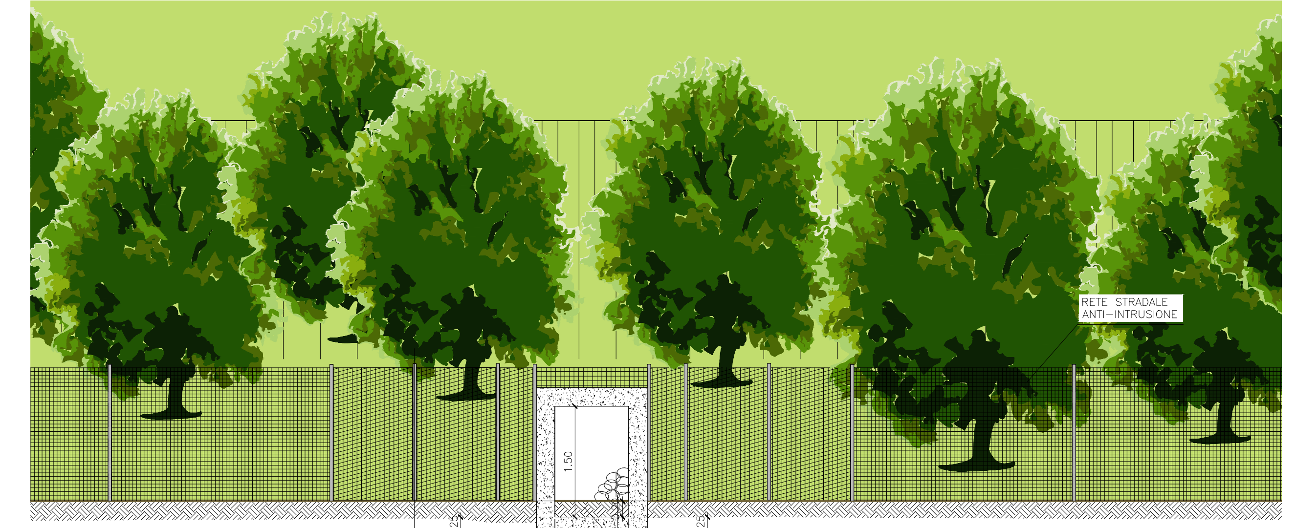
Opere a verde con funzione di attrattore faunistico e invito al varco (tipologico rappresentato: 07 - Rimboscimento in scarpata) Pietrame di media pezzatura per attraversamento animali striscianti Fondo in terra
