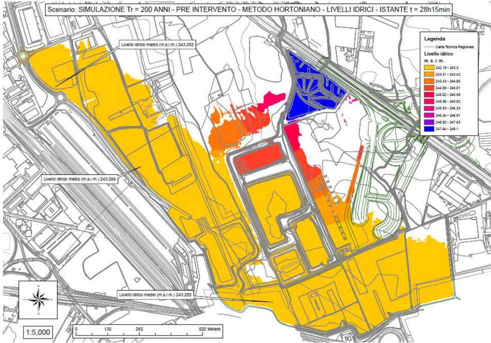
Mappa dei tiranti idrici dopo 28h15min di simulazione (sfioro dalla rotatoria).
