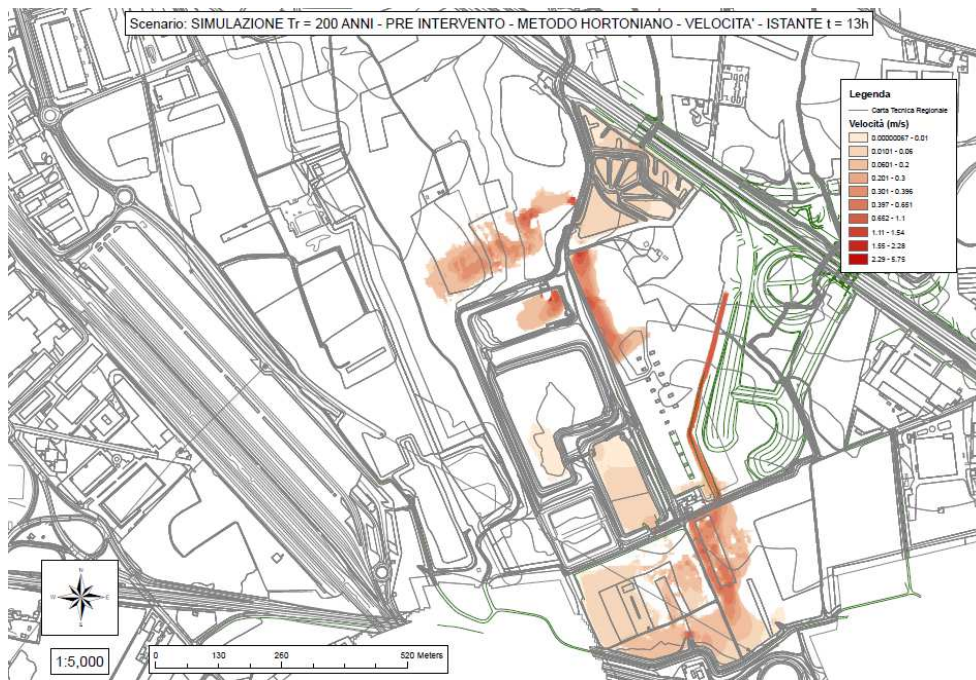
Mappa delle velocità dopo 13 ore di simulazione.
