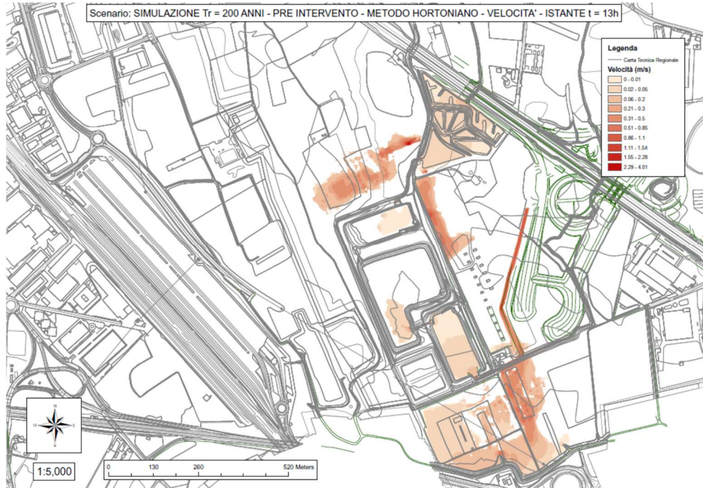
Mappa delle velocità dopo 13 ore di simulazione.
