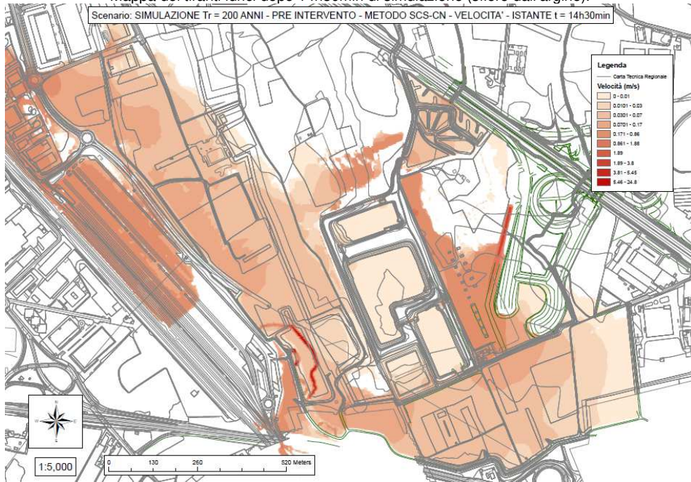
Mappa delle velocità dopo 14h30min di simulazione (sfioro dall'argine).
