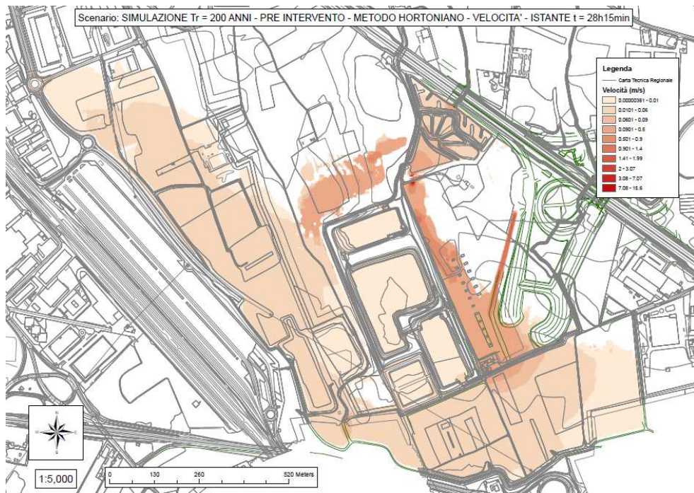
Mappa delle velocità dopo 28h15min di simulazione (sfioro dalla rotatoria).
