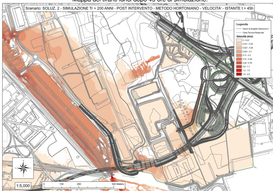
Mappa delle velocità dopo 45 ore di simulazione.
