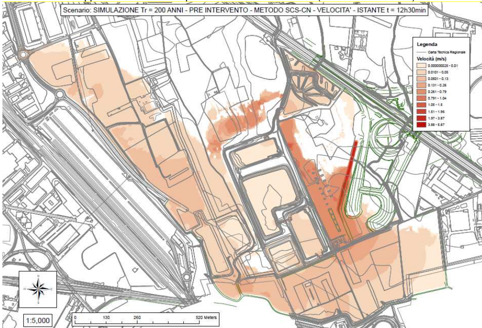
Mappa delle velocità dopo 12h30min di simulazione (sfioro dalla rotondina).
