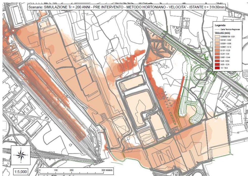
Mappa delle velocità dopo 31h30min di simulazione (sfioro dall'argine).
