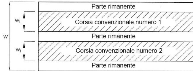
Figura 7 – Esempio di numerazione delle corsie
