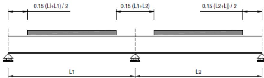
Figura 1 – Modellazione degli effetti dovuti alla fessurazione
