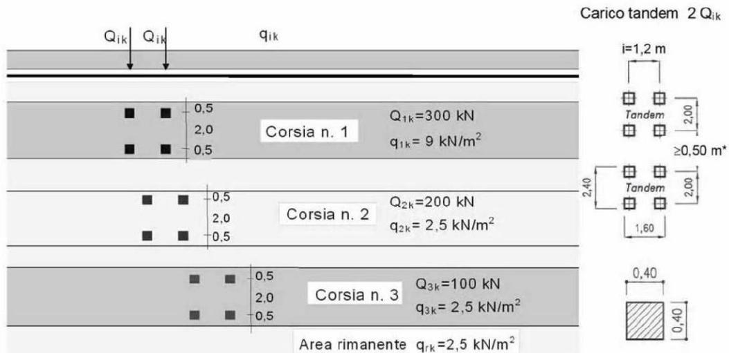
Figura 9 – Schema di carico 1 (dimensioni in [m])
