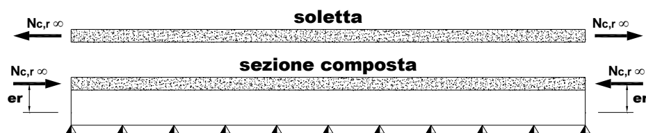
Figura 3 – Schema di riferimento per il calcolo dell'azioni da ritiro sulle travi principali
