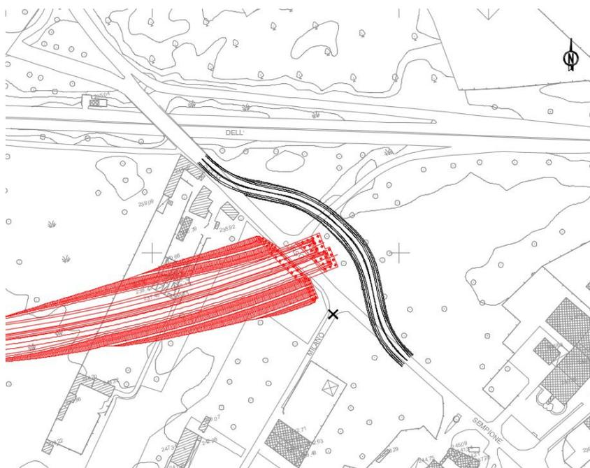
Figura 26 - Planimetria deviazione provvisoria su C.so Sempione (in nero) e aree in lavorazione (in rosso) prevista durante la FASE 3
