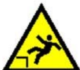
Caduta con dislivello
