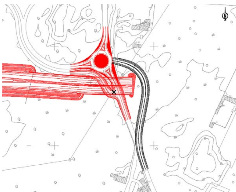
Planimetria deviazione provvisoria su via Calatafimi (in nero) e aree in lavorazione (in rosso)
