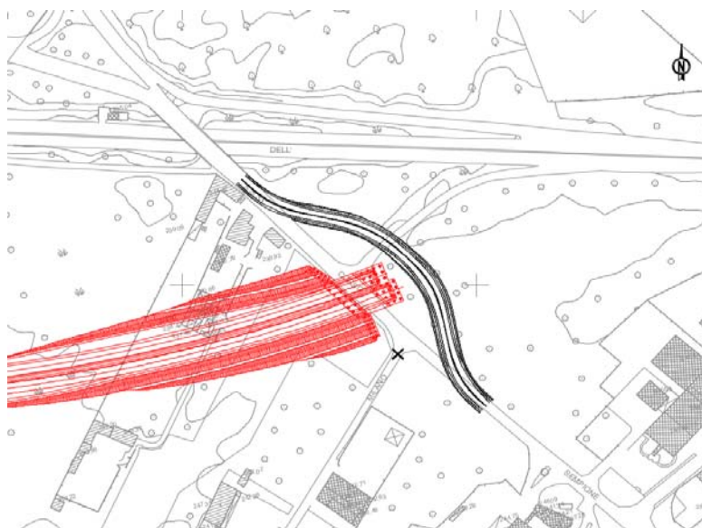
Planimetria deviazione provvisoria su C.so Sempione (in nero) e aree in lavorazione (in rosso)
