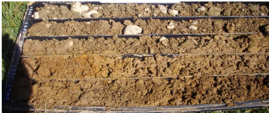
Foto 2/b – Fotografia delle cassette del sondaggio Sc-9-PD realizzato in fase di progettazione definitiva (cassetta n.10 da 45 a 50 m)
