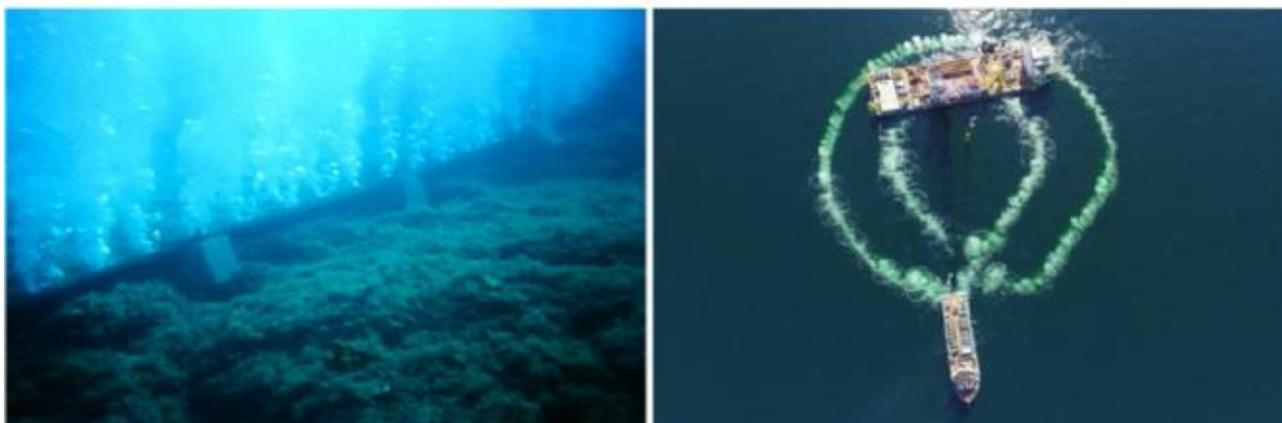
Figura 6-5 Zone con cortina di bolle rilasciata da un tubo perforato poggiato sul fondo (sinistra) e doppia cortina di bolle utilizzata intorno ad una imbarcazione (a destra) (fonte: © hydrotechnik lübeck gmbh)
