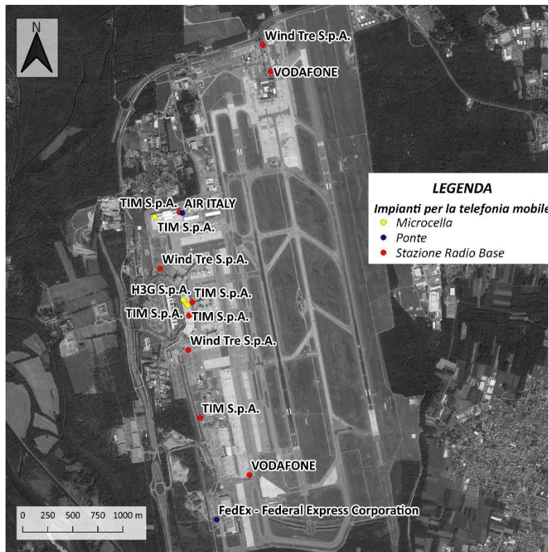
Figura 1: Ubicazione delle Stazioni Radio Base, delle microcelle e dei ponti radio presenti presso l'aeroporto di Milano-Malpensa
