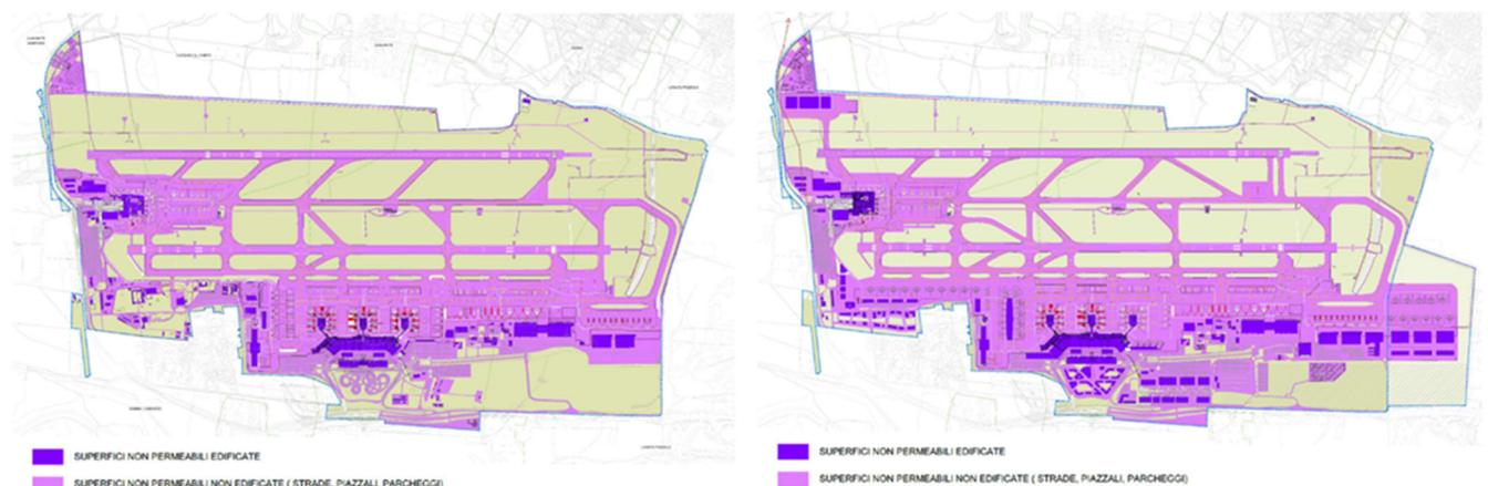
**Figura 5 Aree permeabili/impermeabili – Stato di fatto (figura a sinistra) e Configurazione Masterplan 2035 (figura a destra)**
