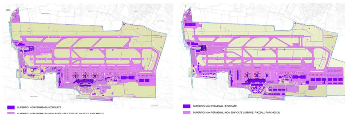
**Figura 9 Aree permeabili/impermeabili – Stato di fatto (figura a sinistra) e Configurazione Masterplan 2035 (figura a destra)**
