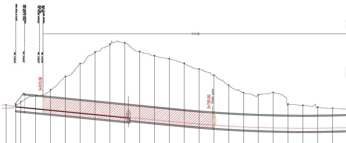
Figura 4.4 – Galleria Naturale Fornaci I - Stato avanzamento dello scavo (in rosso il tratto già realizzato)
