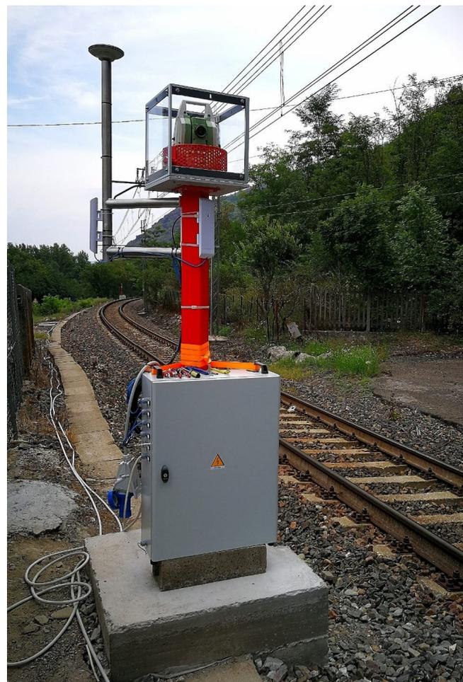
**Figura 4 –Stazione di monitoraggio con teodolite robotizzato**
