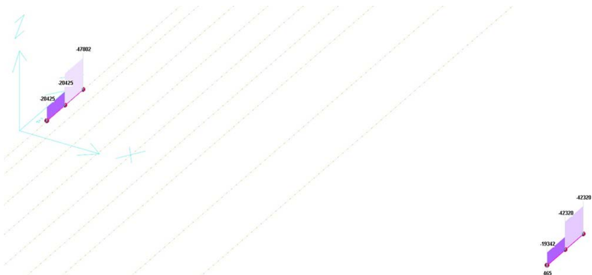
Inviluppo Casi di Carico 1-8 (effetto variabili traffico) - Sollecitazione tagliante
