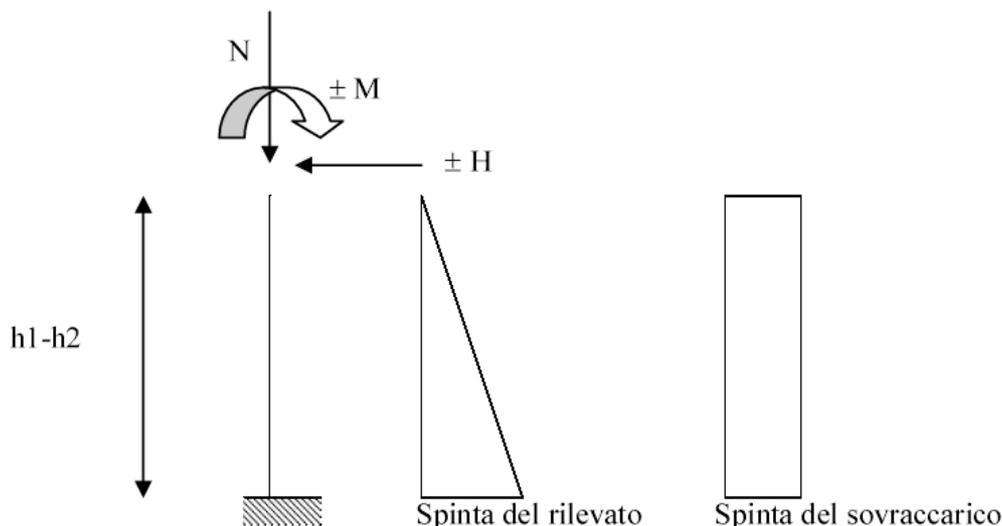
Viene condotta una verifica a presso flessione di un'equivalente sezione a T, con una sola nervatura data dalla somma delle due nervature, a partire dal bordo superiore del paramento prefabbricato, con passo di esplorazione "d"
