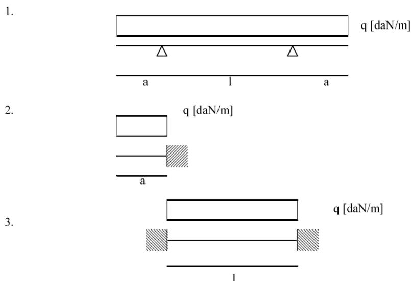
In quanto per le caratteristiche geometriche del pannello è sempre  $a > l/2$  lo schema di carico più gravoso si ha per la condizione 2, per cui nel calcolo si adotta lo schema di mensola incastrata nella nervatura.
