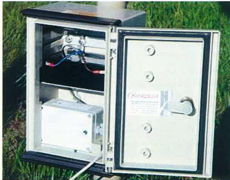
Figura 1: Apparecchiatura per il monitoraggio del traffico veicolare
