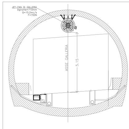
DETTAGLIO ALIMENTAZIONE VENTILATORE
