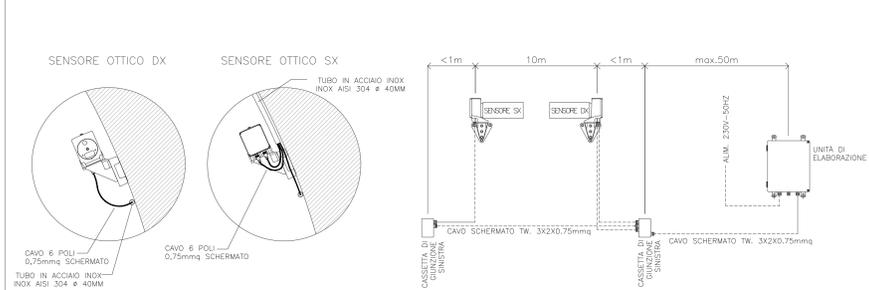
PARTICOLARE DI INSTALLAZIONE ANEMOMETRI
