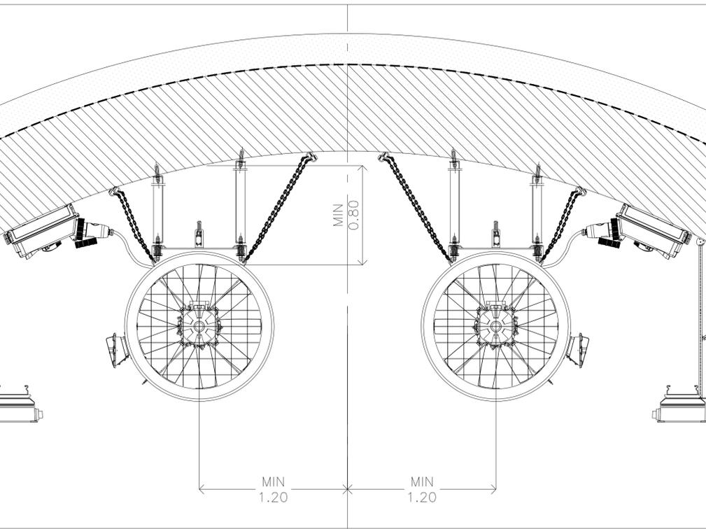
DETTAGLIO ALIMENTAZIONE VENTILATORE
