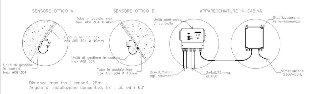
PARTICOLARE DI INSTALLAZIONE OPACIMETRI
