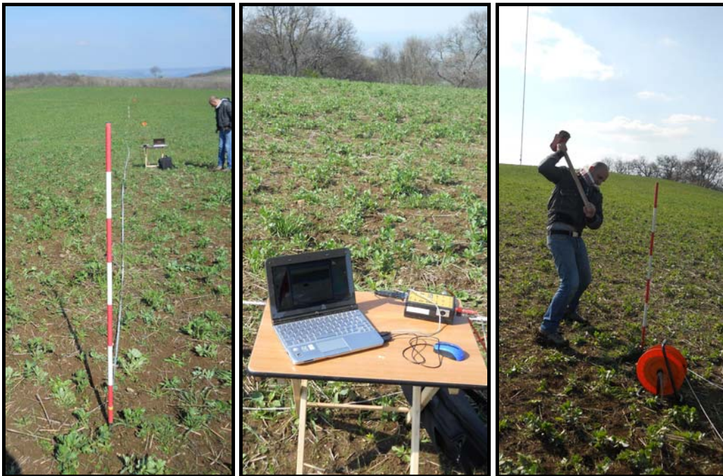
Documentazione fotografica relativa alle prove MASW M2 e a rifrazione R2
