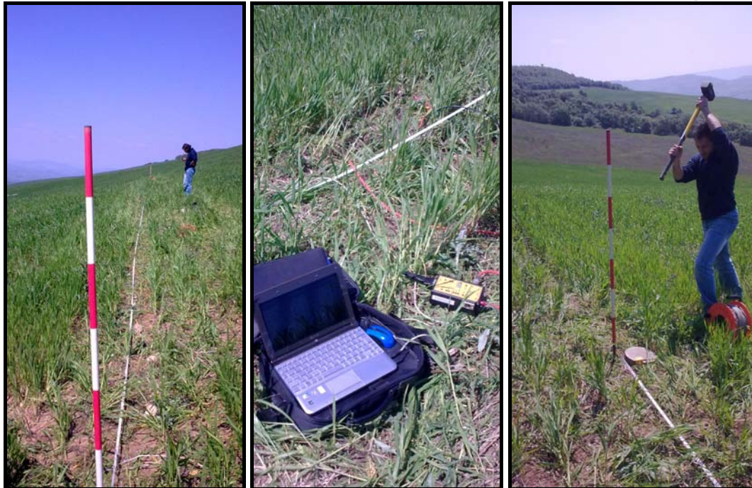
Documentazione fotografica relativa alle prove MASW M3 e a rifrazione R3
