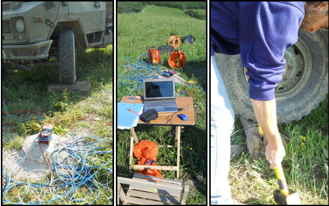
Documentazione fotografica relativa alle prove down hole DH5
