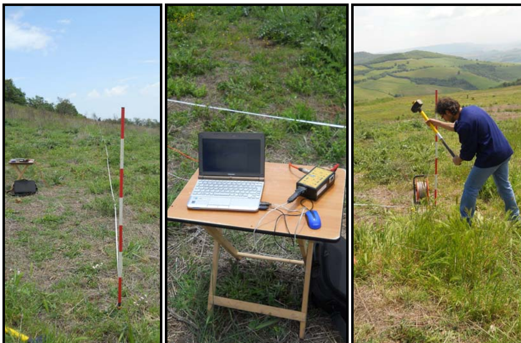
Documentazione fotografica relativa alle prove MASW M4 e a rifrazione R4
