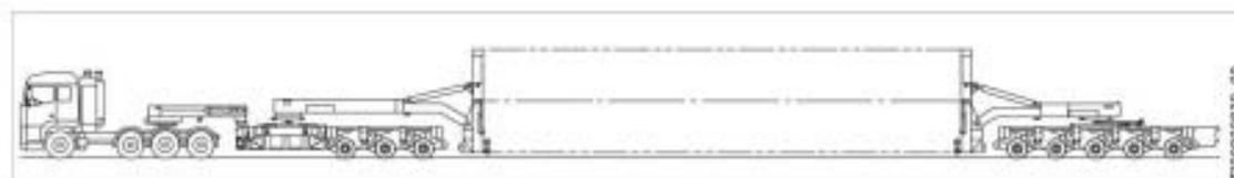
Fig.18 – Esempio di mezzi per il trasporto dei pezzi degli aerogeneratori
