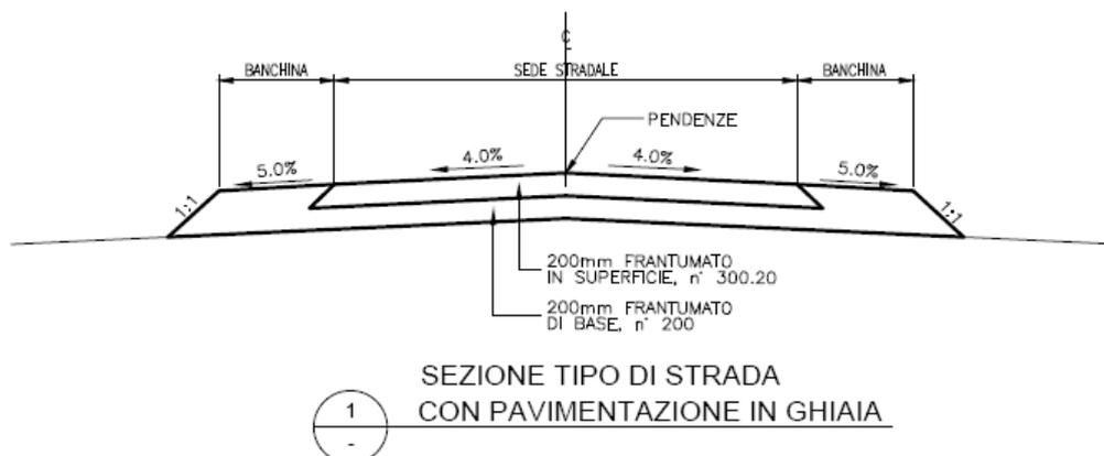
Fig. 19 – Sezione tipo strada con pavimentazione in ghiaia
