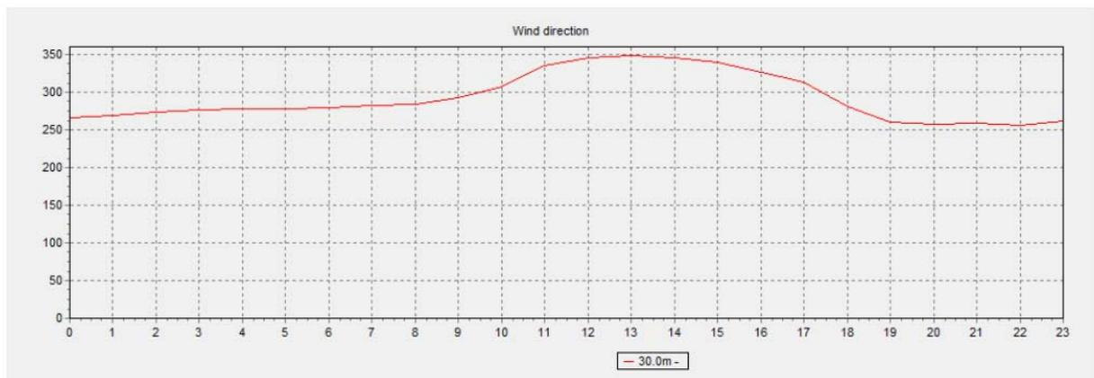
**Figura 19e:** Variazione giornaliera della direzione del vento (su base di dati filtrati relativi ad un anno di misurazioni della stazione anemometrica ST01 a 30 metri).
