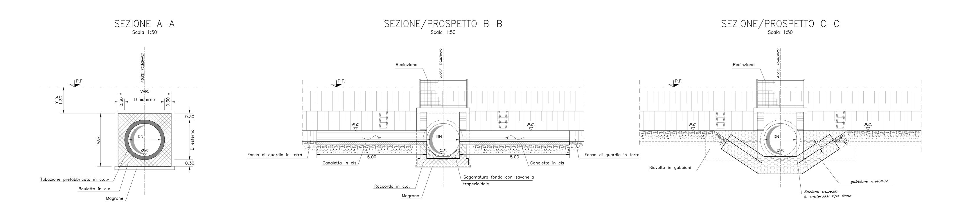
NOTA 1: La protezione in gabbioni e materassi reno è prevista per le sole opere che presentano un'asta idraulica incisa e definita in ingresso e/o in uscita dal manufatto idraulico
