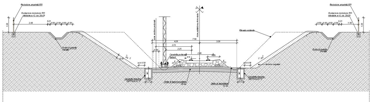
Figura 2: sezione tipologica in trincea
