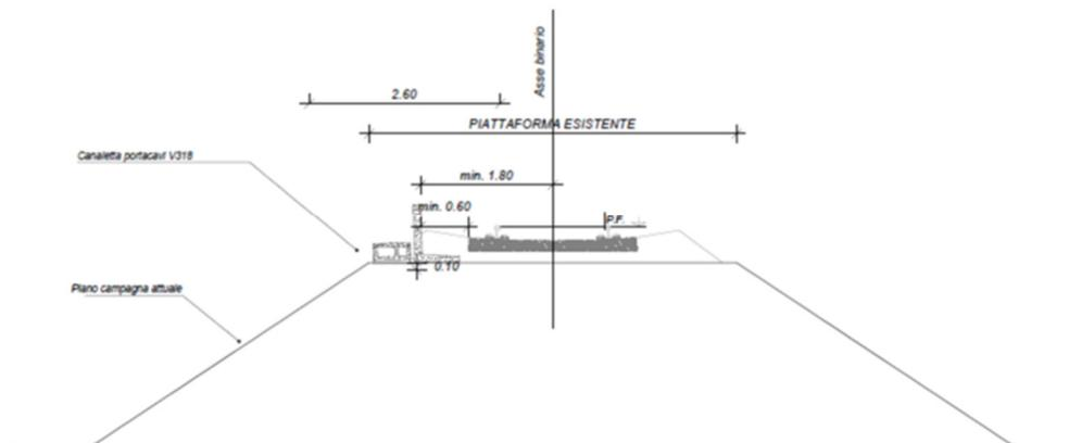
Figura 4: sezioni tipologiche in corrispondenza della zona del Torrente Tittadegna
