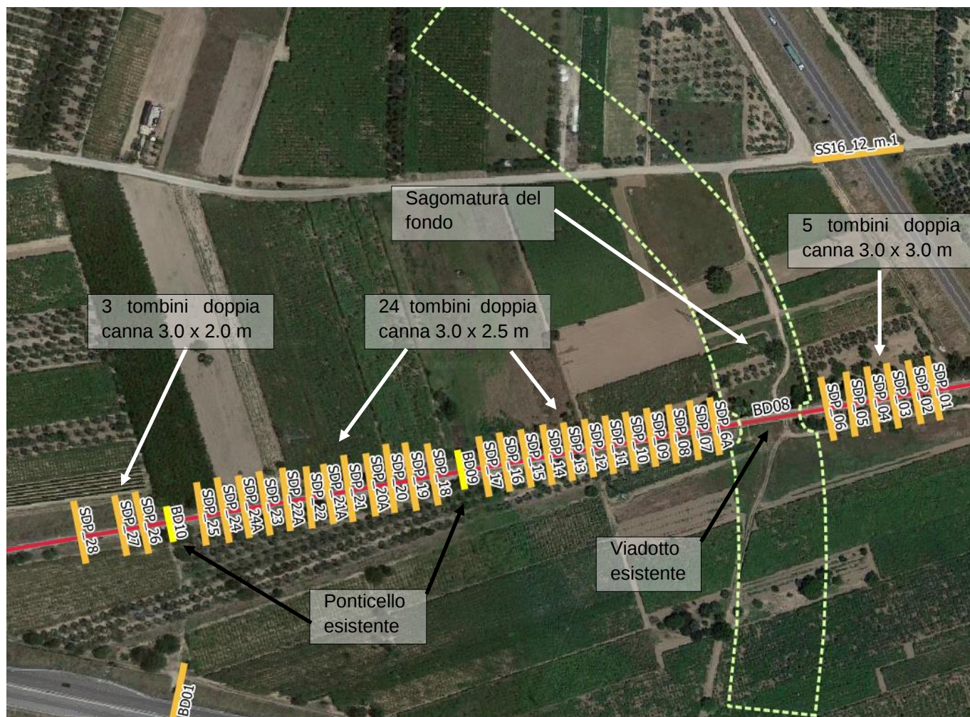
Figura 30 ipotesi progettuale - Inquadramento planimetrico tombini di trasparenza idraulica
