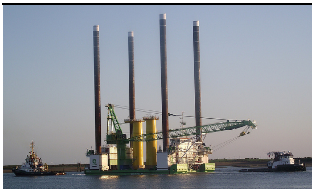
Figura 3.41 Esempio di Chiatta d'Installazione di Tipo Jack Up
