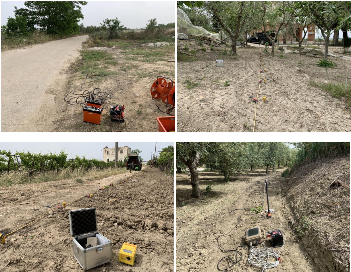
Figura 2: Strumentazione impiegata per le prove di superficie mediante geoelettrica (in alto a sinistra) e Masw (in alto a destra),Hvsr (in basso a sinistra) e Masw 2D (in basso a destra).
